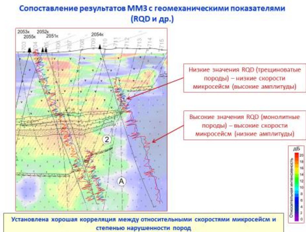
Рисунок 2.3 – Сопоставление разреза ММЗ вдоль рабочего профиля с геологическим разрезом, известным по результатам многолетнего изучения района. Три наклонные скважины (глубиной до 1000 м) запланированы специально для проверки ММЗ. Обнаружена хорошая корреляция разреза ММЗ и механических свойств керна вдоль скважин [Горбатиков, Алешин, 2012]
